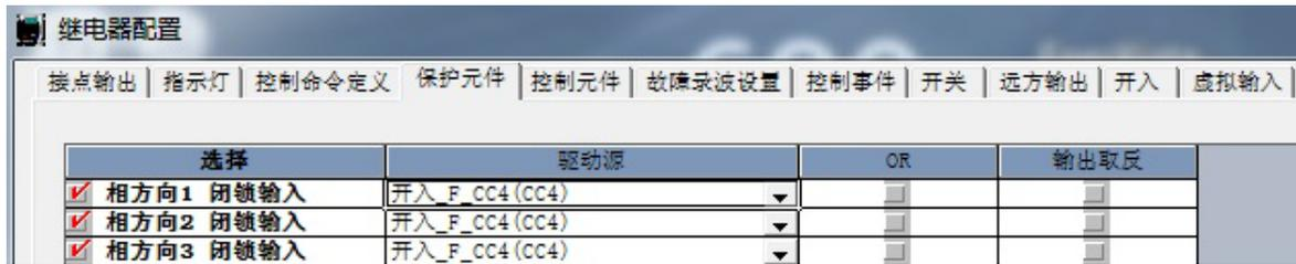
图 30：通过输入配置方向元件闭锁
