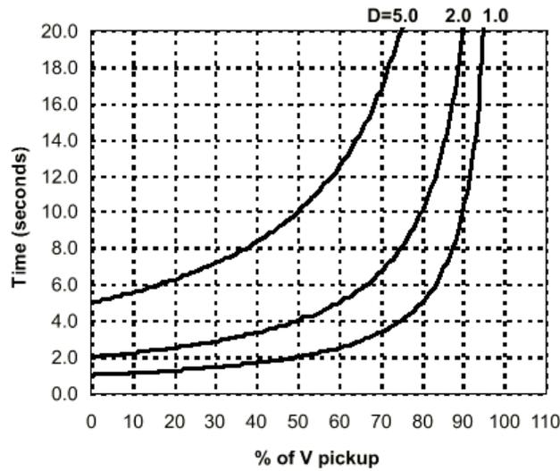
图 35: 反时限低电压曲线
