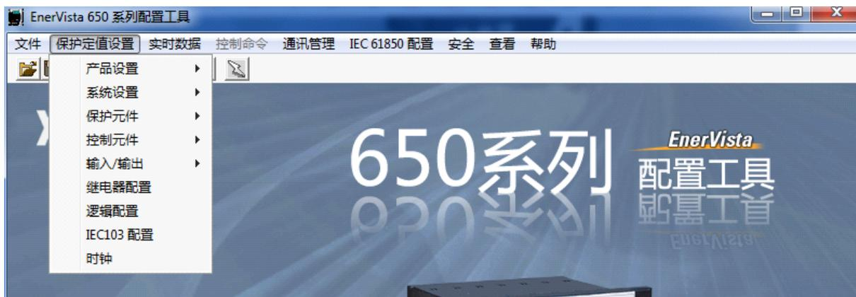
打开 IEC103 配置工具时，将会询问是否打开一个已存在的“M650iec103.cfg”配置文件，若选择取消，用户将会进入 IEC103 配置工具并且没有文件被选择。可通过“恢复配置”按钮从 M650 中恢复配置文件。用户修改配置文件后，按下“发送配置”按钮可将新配置文件发送至 M650。为了使新配置生效，必须重启装置。
