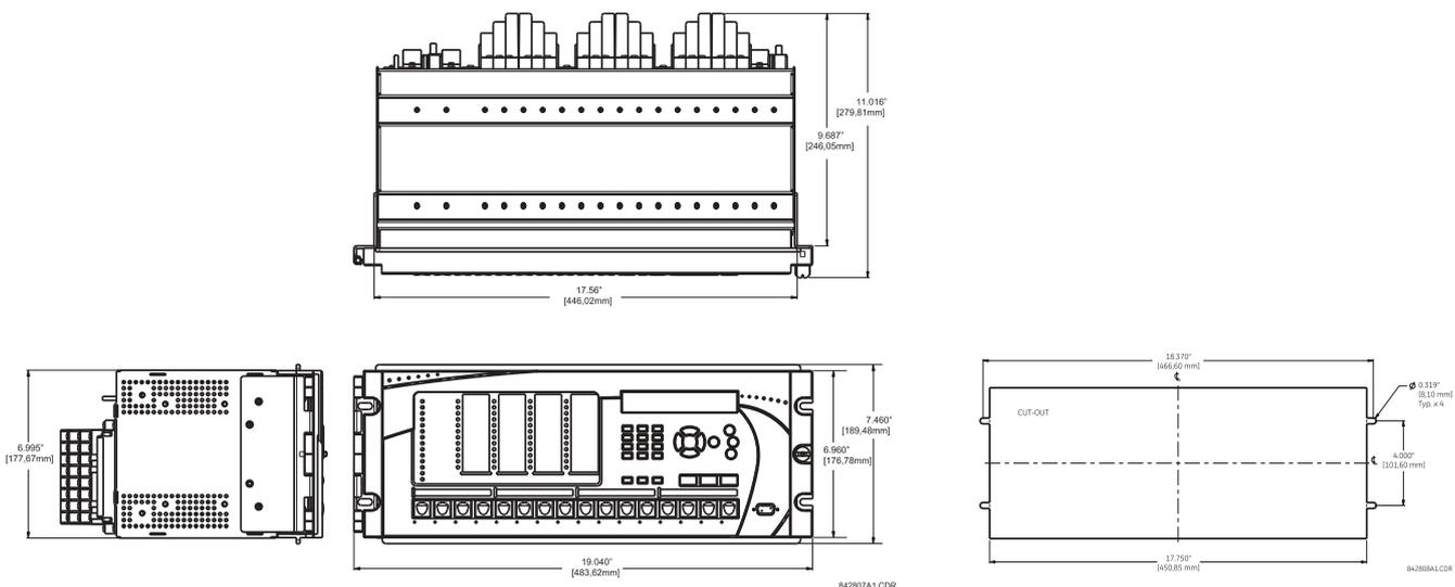
装置外形及安装开孔尺寸
