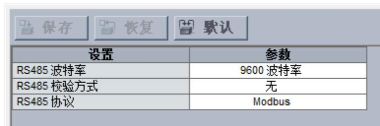
图 21: 串行端口配置定值
