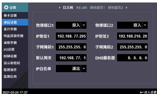
图 4-44 以太网口设置界面
