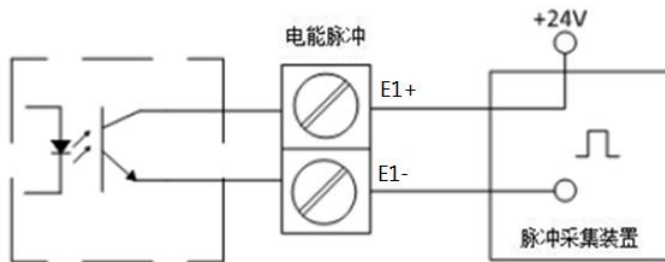
图 3-10 电能脉冲输出接线
