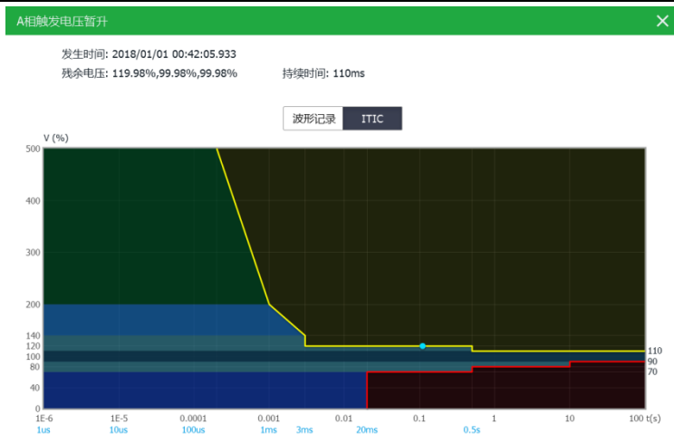
图 5-5 ITIC 电压容限曲线
