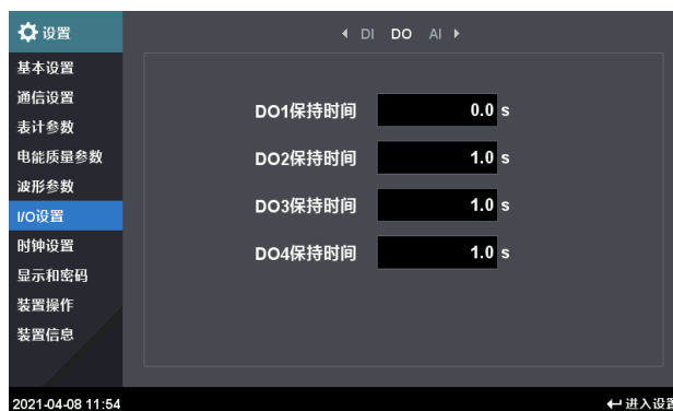
图 4-63 开关量输出设置界面
