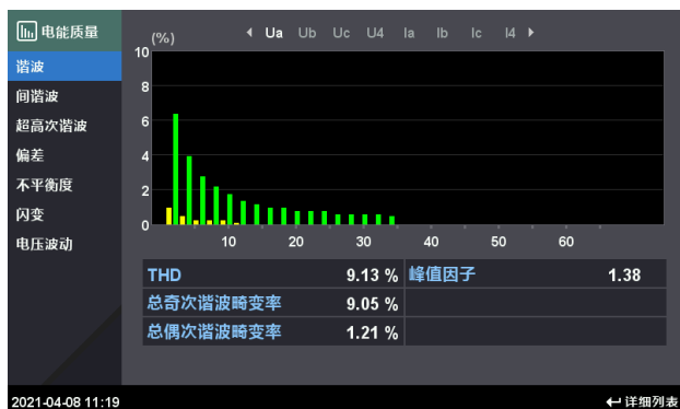
图 4-23 谐波电压显示界面
