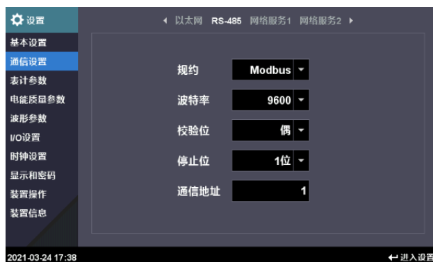
图 4-45 RS-485 串口设置界面
